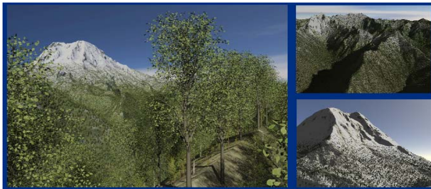
Abbildung 3 - Visualisierung eines 80x80km großen Datensatzes mit 134 Millionen Dreiecken
